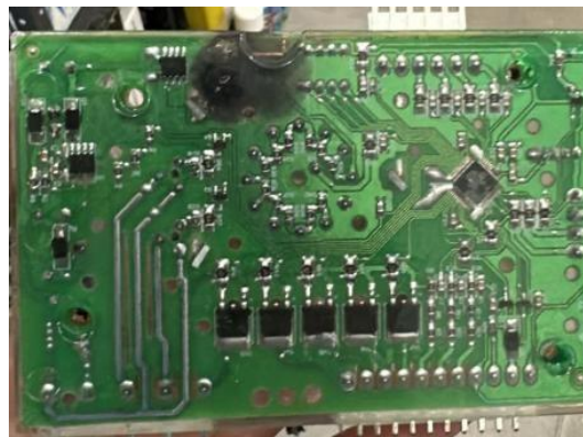
Figura 9: Placas Eletrônicas queimadas por curto-circuito em componentes da lavadora ou descargas atmosféricas
