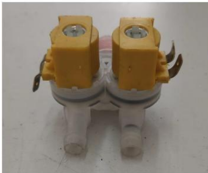
Figura 3: Eletroválvulas com bobina violada (marcas de desmontagem do corpo) e terminal dobrado manualmente
